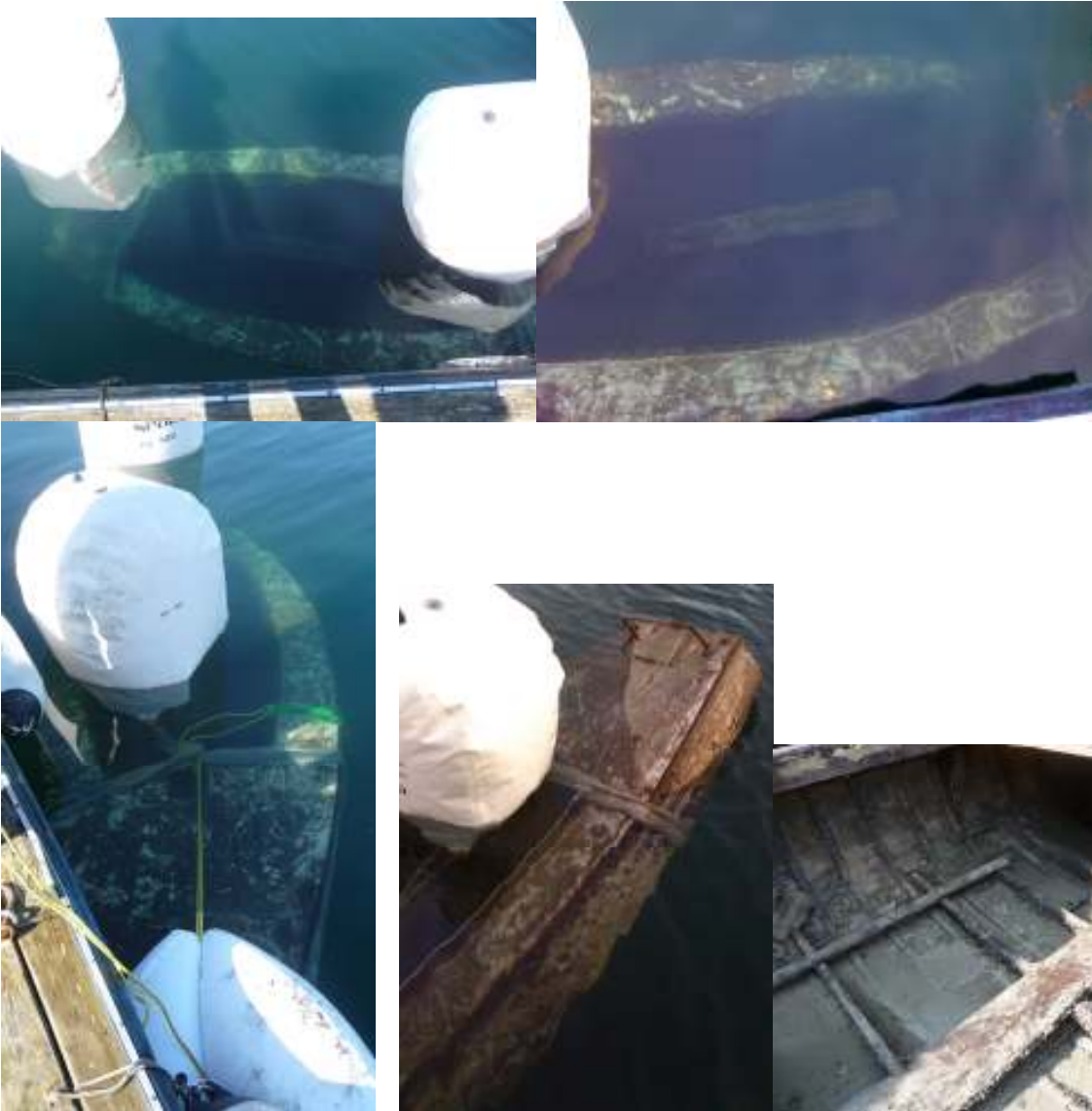
Nöck I wird im Herbst 2011 mit Hilfe eines Tauchers und unter Wasser aufblasbaren Luftsäcken gehoben
