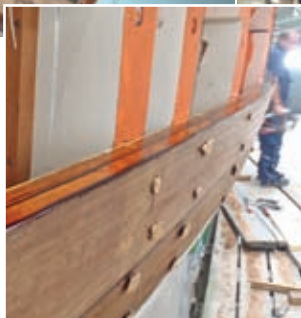
Neue Planken für die „Gudrun“, Baujahr 1918. Die Entscheidung fiel für den traditionellen Aufbau mit Faden, um einen Rumpf aus einem Guss zu erhalten.
